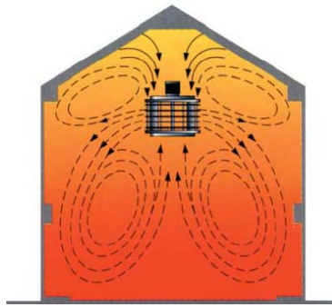
Figura 58. Desestratificació de l'aire de calefacció.
