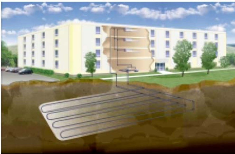
Figura 49. Intercanviador horitzontal (Font: McQuay).
